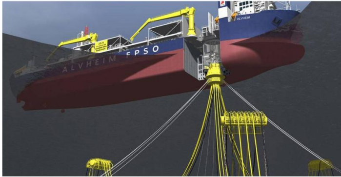
ROTERE: Arendalsbedriften APL leverer svivelsystemet som båten skal kobles til. Skipet kan rotere rundt denne. Foto: APL
